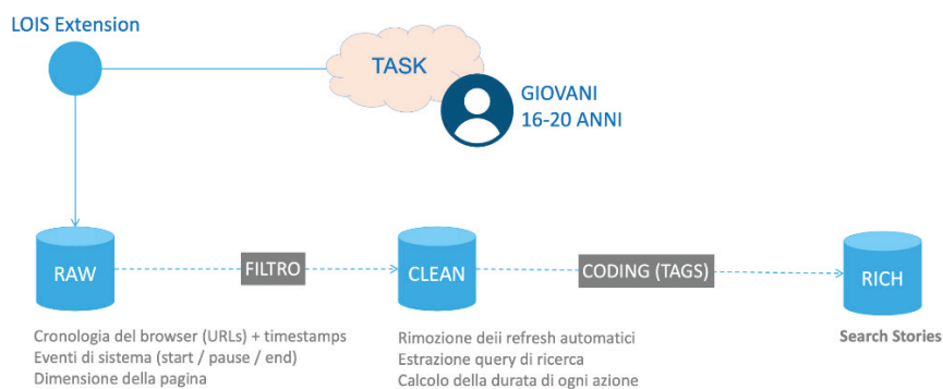
Figura 3 - Il processo di raccolta pulizia e codifica dei dati di navigazione
